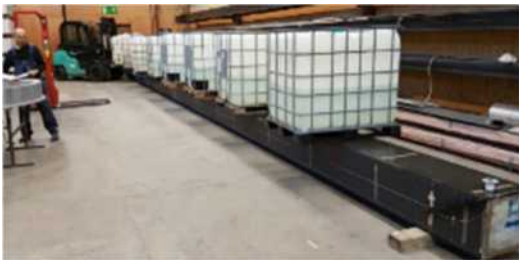
Bild 23 (Oskar Bruneby Kolfiber balk) Provning nedböjning av balkelement.
