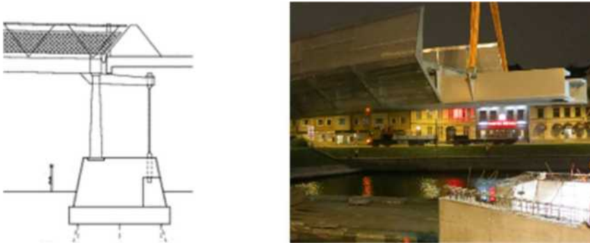
Figur 47 A visar inspänningsarm på Varvsbron i Helsingborg B (foto Oskar Bruneby) Visar bro Malmö live som har arm med lager både uppe och nere.
