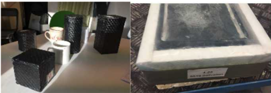
Figur 97 (Foto Oskar Bruneby). Visar provkroppar och provning av traditionella prov som frost tryck och brand
