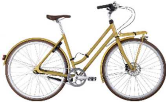
Figur 2 (bild från Monark.se) Standardcykel däcksvidd ca 40mm men det finns ballongdäck som är 145mm.
