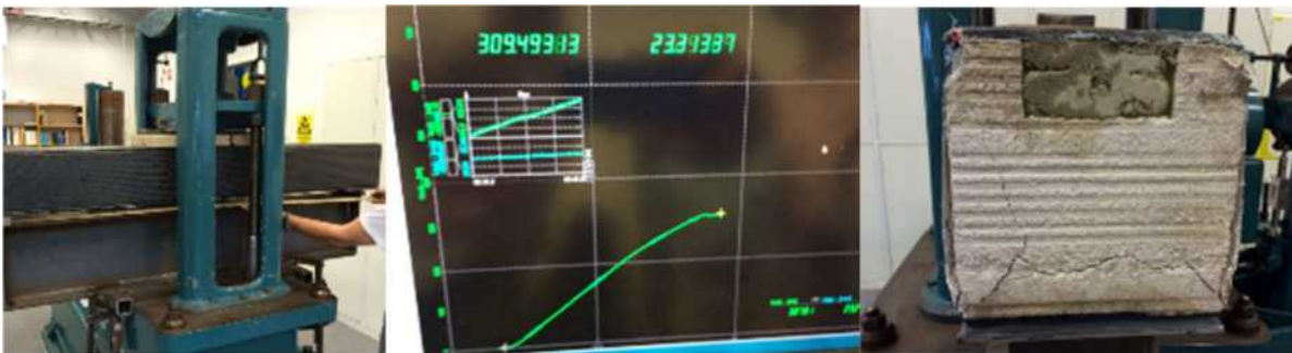
Figur 96 (Foto Oskar Bruneby). Visar provnings av olika samverkanssystem vi utveckling av kärnmaterial då konventionella inte var kostnadseffektiva vi denna volym.
