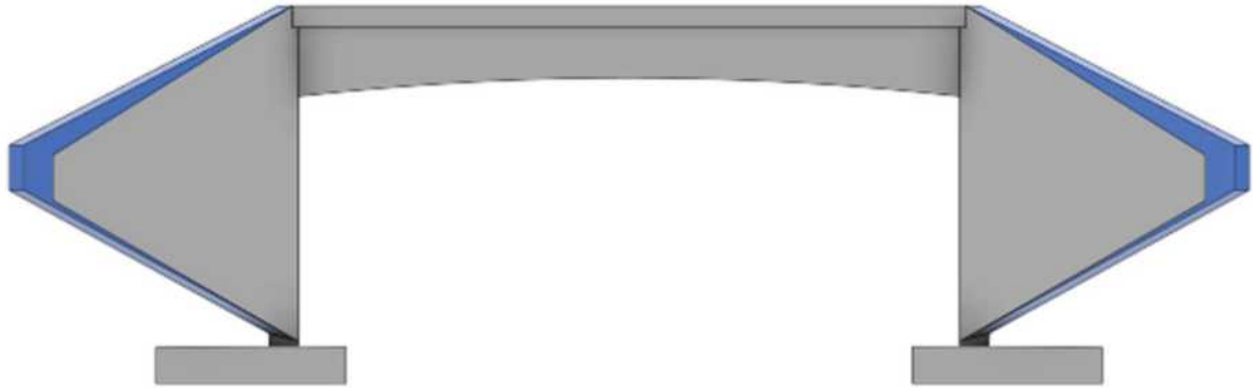
Figur 15 (Skiss visar släntlutning 1:1,7 grå och 1:2 blå.) Släntlutningar då vingen blir kortare än ca 9,5m kan ganska enkelt förlängas med hjälp av att bara förlänga vingen
