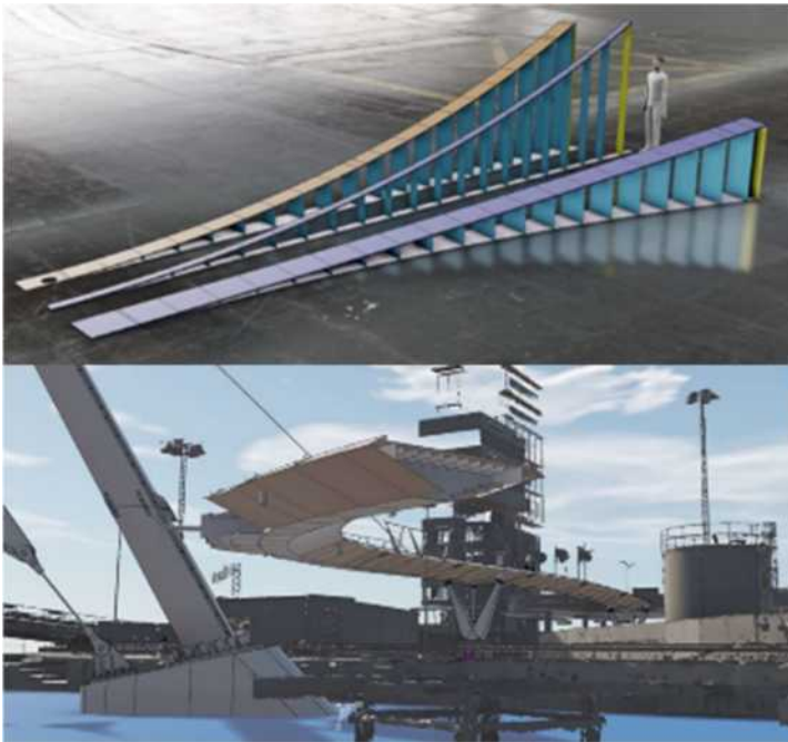
Figurer 147 skisser från Varvsbron hanterade plåtar som var datogenererade med avancerade plåt förändringar från verkstad till montage och sedan uppspanning. Först den datogenererade geometrin sedan kompensera för deformationer i montage och uppspanning. Detta genererade en knepig geometri som vi bröt ned till mått från ett vridet plan och sedan mätpunkter varje 500mm för tillverkning och kontroll.
