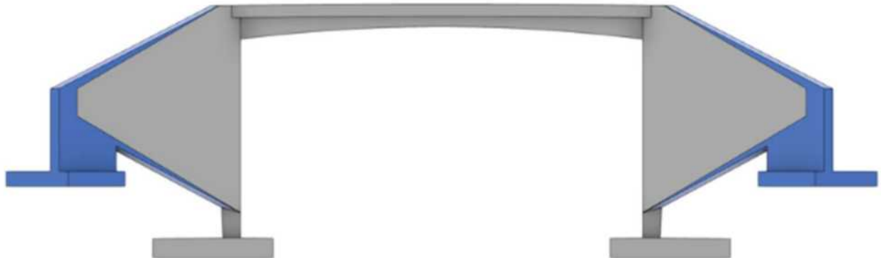
Figur 16 (Skiss visar släntlutning 1:1,7 grå och 1:2 blå.) I detta fall blir vingen för lång. Detta innebär att man måste förlänga vingen med stödmurar som blir ganska dyra för att man förlänger byggtiden med ca 1 månad. Man behöver först bygga bron och sedan göra markarbete för att kunna slutföra stödmurar, motfyllningar och räcke. Det vore en bra kostnads effektivt om man kunde synkronisera Trafikverkets regler och prefabindustrin så man kunde bygga lättare prefabricerade stödmurar men detta kräver att man bultar räcket på utsidan.
