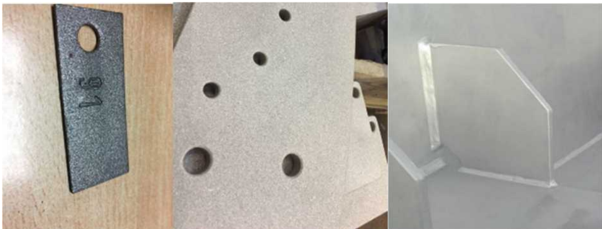
Figur 76 (foto Oskar Bruneby) A Visar blåstring SA 2,5. B Visar väl utförda radier i hål på ett räcke C Visar fasing i en notch.
